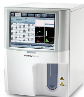
Рассеяние лазерного излучения под тремя углами, сфокусированный поток и использование химических красителей создают возможности для более качественной дифференцировки лейкоцитов на 5 субпопуляций даже в пробах с высоким содержанием эозинофилов.
