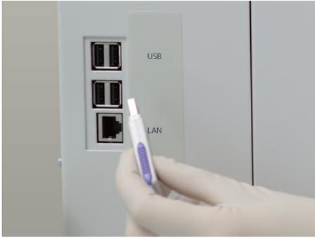
С левой стороны аппарата находятся 4 USB-порта. Они позволяют пользователям анализатора BC-5150 без труда передавать данные и подключать к анализатору принтер, клавиатуру, мышь, сканер штрихкода и т.д.
