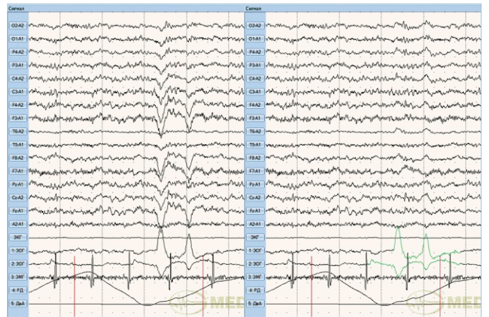
Справа (сплит-режим) – результат автоматического подавления артефактов от ЭОГ по двум каналам (вертикальной и горизонтальной составляющей движения глаз)
