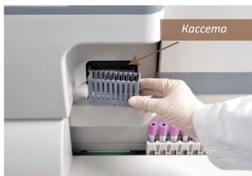
Кассета, которая используется для переноски предметных стекол, легко загружается спереди SC-120 и автоматически транспортируется внутри по направляющей.
